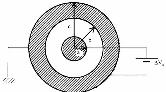
15. La figura muestra dos largos cilindros conductores concéntricos, el interior con carga total  $+q$  y el exterior con carga total  $-q$ . Suponiendo que la longitud  $L$  de los cilindros es mucho mayor que las dimensiones radiales ( $L \gg c$ ), calculad:
