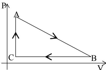
13) Un gas experimenta el ciclo de la figura 100 veces por minuto. Determine la potencia generada si en A la presión es 30 atm y el volumen 2 l y en B la presión es 10 atm y el volumen 8 l?
