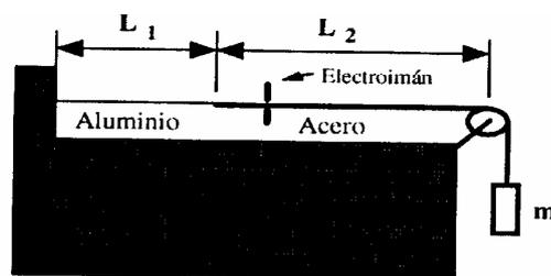
(a) ¿Cómo deben ser  $y_1$  e  $y_2$  en el punto de unión?, ¿Cómo deben ser las velocidades de desplazamiento transversal  $\partial y_1 / \partial t$  y  $\partial y_2 / \partial t$ ? (b) Si el electroimán fuerza al alambre de
