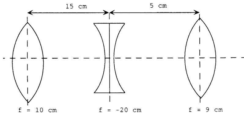
9) Un sistema óptico está formado por una lente delgada convergente de distancia focal  $f$  y una lente delgada divergente de distancia focal  $-f$ , colocada a una distancia de  $2f$  de la primera. Determinad la posición de los focos del sistema analíticamente en función de  $f$  y mediante un trazado de rayos.
