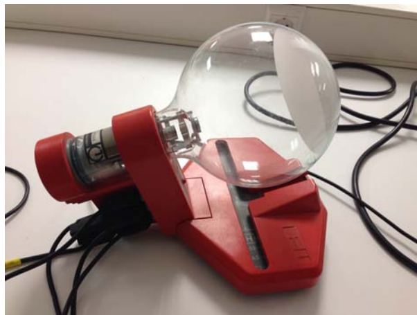
Figura 2. Montaje experimental general (arriba) donde observamos la fuente de alimentación del filamento de baja tensión (izquierda), la fuente de alto voltaje (derecha) y tubo de electrones (centro y detalle abajo).
