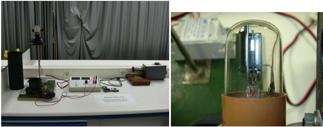
Figura 4: Montaje experimental para observar el efecto fotoeléctrico
